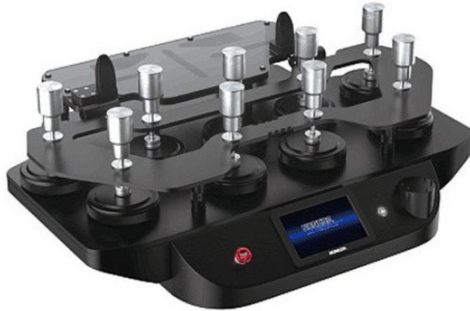
**YG227N乱翻式起球测试仪适用范围** 用于采用随机翻滚法检测织物的起球性能 **仪器特点** 1. **工作原理**: 织物在的试验仓中, 通过不锈钢叶轮片的旋转作用下, 与软木内衬进行持续、随机摩擦而产生起毛起球, 试验仓内需注入压缩空气以增强翻转、摩擦作用。 2. 配备符合ISO标准要求的叶轮。其他标准的叶轮也可定制。 3. 传动机构选用品质的电机驱动和进口精密滚动轴承, 并采用独特的减震技术, 明显地降低了运转时的噪声。 4. 选用欧姆龙品牌定时器, 稳定可靠。**适用标准** GB/T4802.4□ISO 12945-3□ASTM D3512□DIN53867□JIS L1076等相关标准。南通宏大实验仪器有限公司致力于提供织物测试, 竭诚为您服务。深圳织物悬垂性测定仪标准
